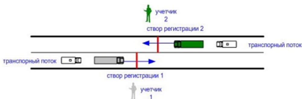
Рисунок 2 - Расположение «створов регистрации» при учете интенсивности движения на перегоне
