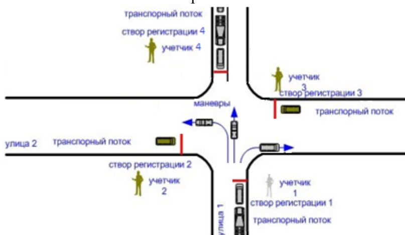
Рисунок 3 - Расположение «створов регистрации» при учете интенсивности движения на перекрестке
